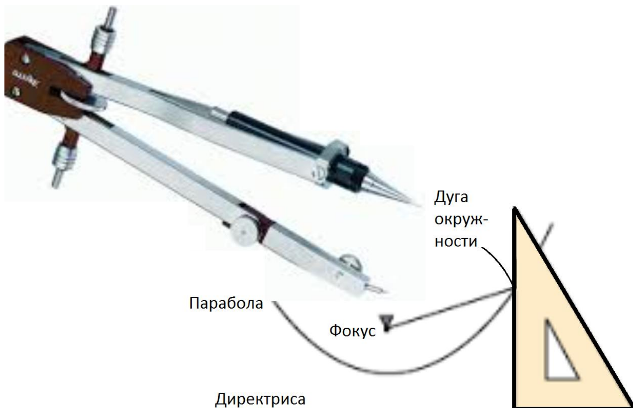
Рис. 1. Построение параболы циркулем и угольником
