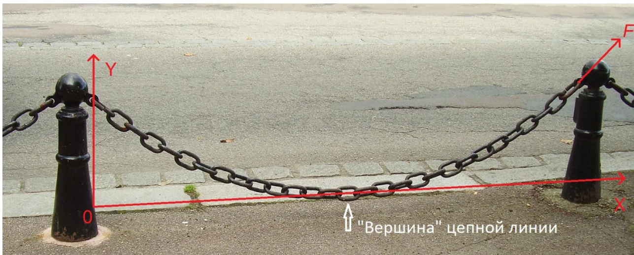
Рис. 4.1. Висящая цепь образует цепную линию
