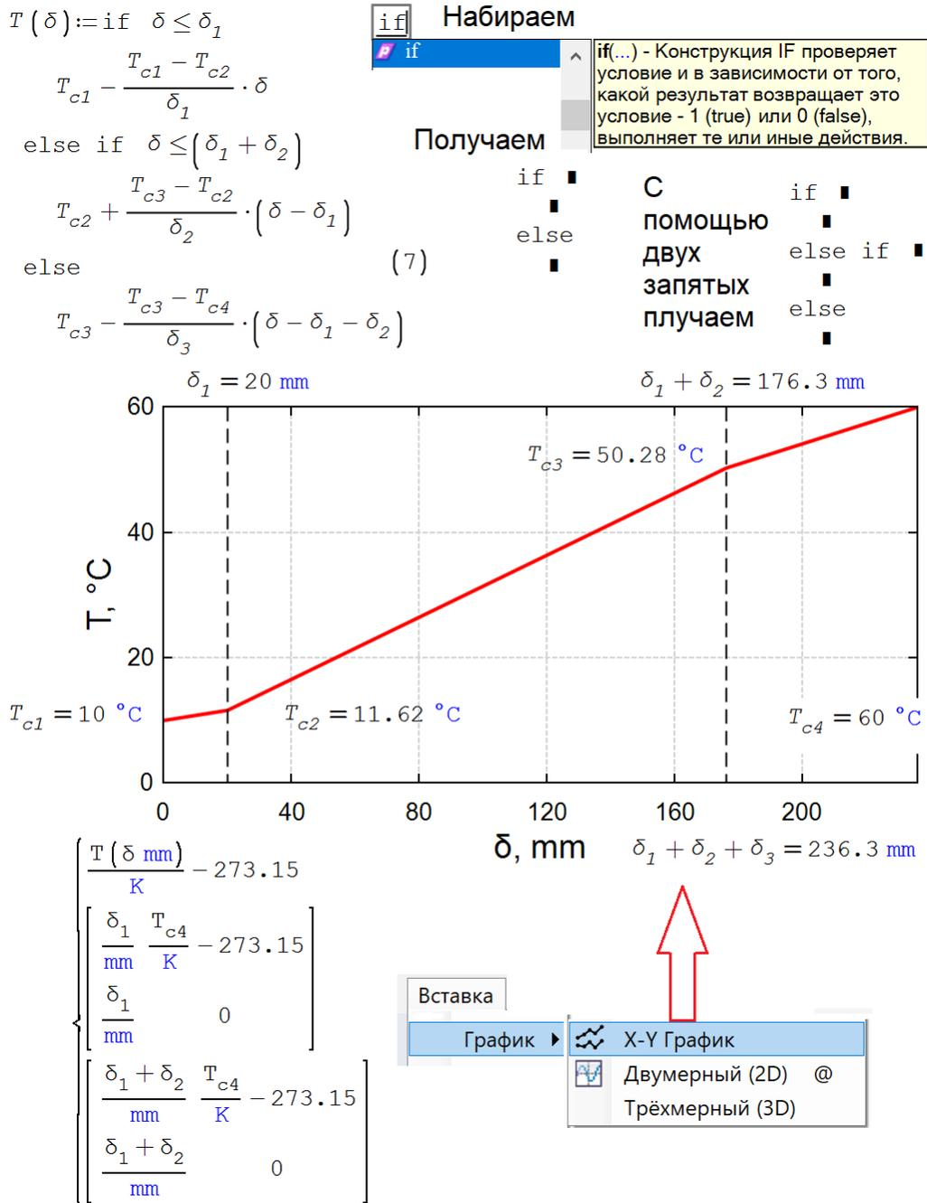
Рис. 5. Построение графика изменения температуры по толщине стенки
