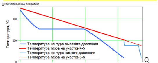
Рис. 10. Завершение расчета двухконтурной ПГУ: расчет термического КПД и построение тепловой диаграммы котла-утилизатора (T-h диаграммы)
