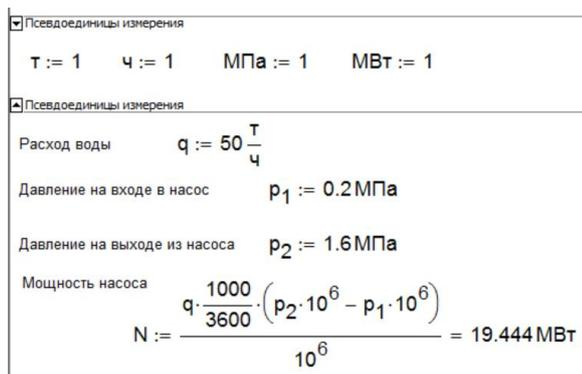
Рис. 3. Попытка расчета мощности насоса в среде Mathcad без задействования механизма единиц измерения (вариант 2)
