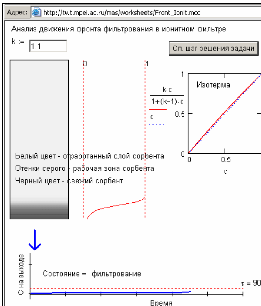
Рис. 5. Реализация в Интернете математической модели ионитного фильтра водоподготовки электростанции
