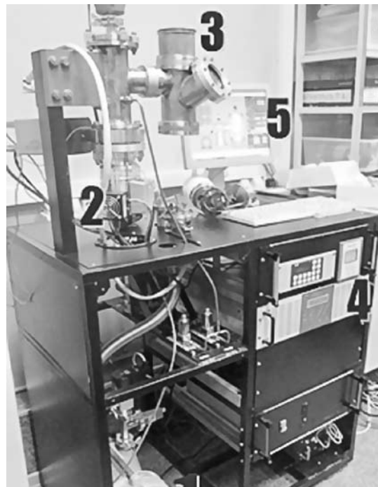
Рис. 3. Вид малогабаритной вакуумной установки модульного типа, которая состоит из рабочей камеры, системы откачки, системы управления и контроля. Рабочая камера (3) изготовлена из нержавеющей стали и имеет смотровое окно из кварцевого стекла для наблюдения за процессами. Двухступенчатая система откачки включает два насоса: форвакуумный (1) и турбомолекулярный (2). Система управления и контроля включает несколько приборов (4) и монитор (5).
