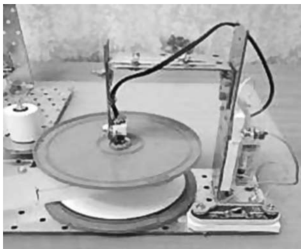
Рис. 8. Фотографии готового сейсмографа
