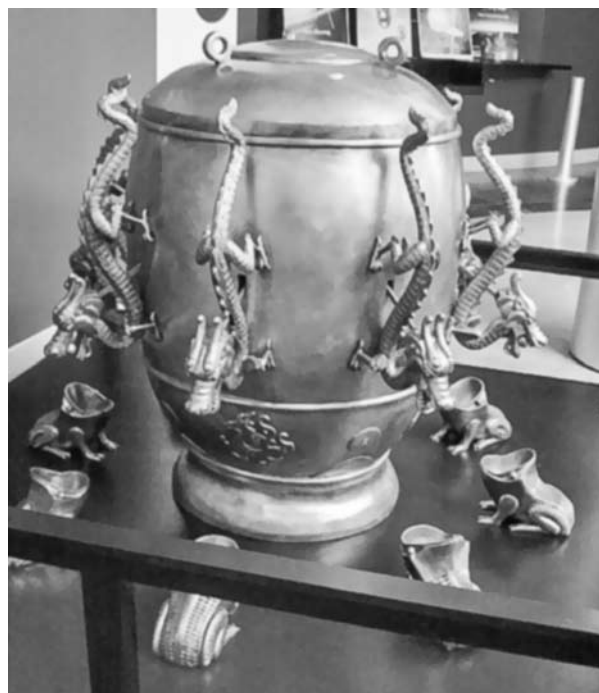
Рис. 1. Сейсмоскоп Чжан Хэна
