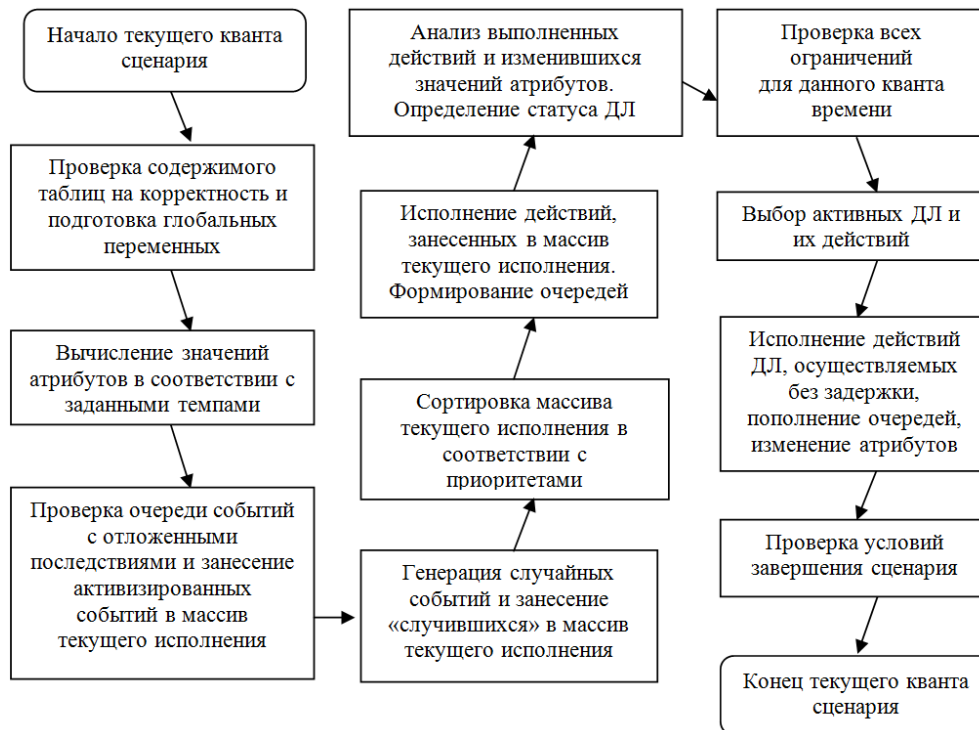
Рисунок 10. Упрощенная схема функционирования генератора сценариев
