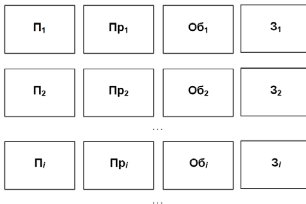
Рисунок 9. Комбинационная модель состава просветной РЛС, состоящая из множества блоков: передатчиков (П i ), приемников (Пр i ), объектов (Об i ) и заказчиков (З i )
